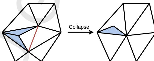
图 3.3: 破坏流形性质的坍塌操作
